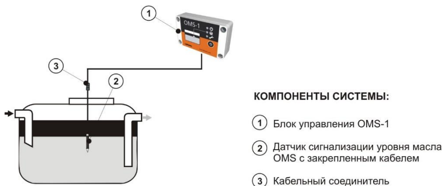
Рисунок 1. Контроль работы маслоочистителя с помощью устройства аварийной сигнализации OMS-1
