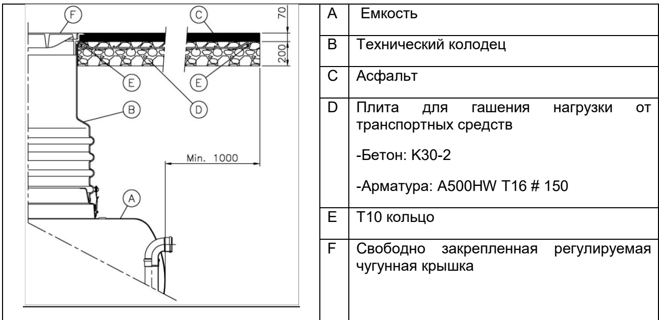
Рис 6 Структура плиты распределения нагрузок
