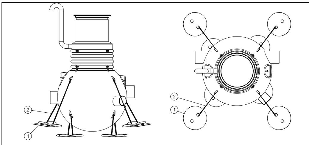
Рис 5. Установка регулирующего колодца NS50/150 - NS150/450 на плиты из армированного стеклопластика.
