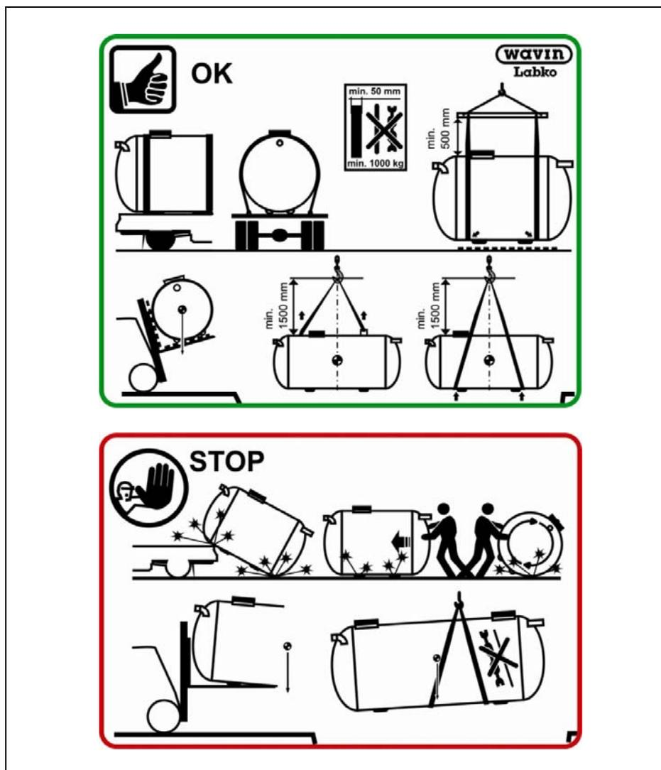
Рис 2. Инструкция по транспортировке.
