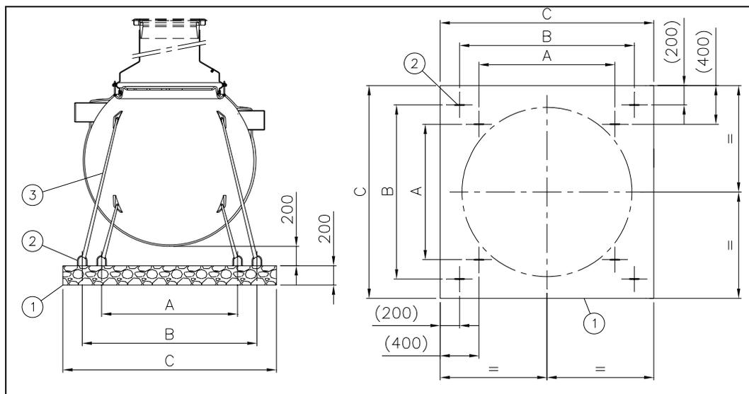
Рис 3. Установка регулирующих колодцев NS50/150 - NS150/450 на ж/б плите.
