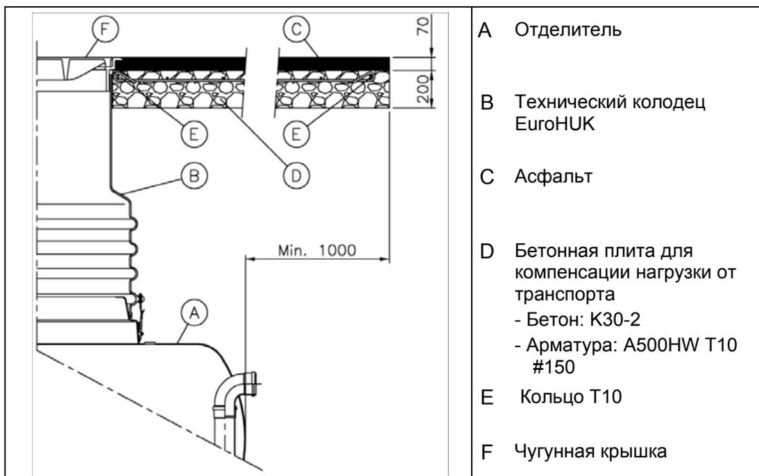
Рис 7. Конструкция плиты для компенсации нагрузки от автотранспорта.
