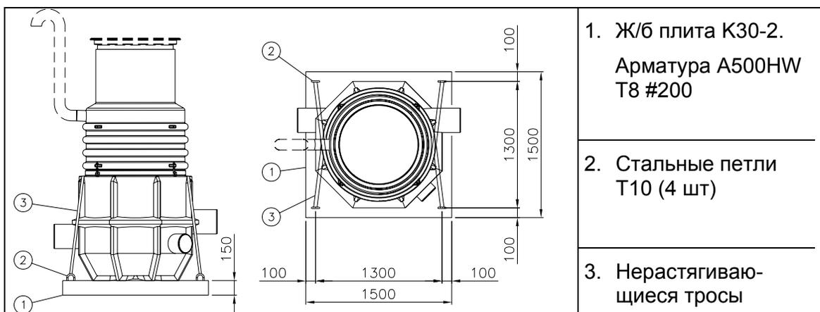
Рис. 3 Крепление регулирующего колодца NS3/9 – NS40/120 (при необходимости).
