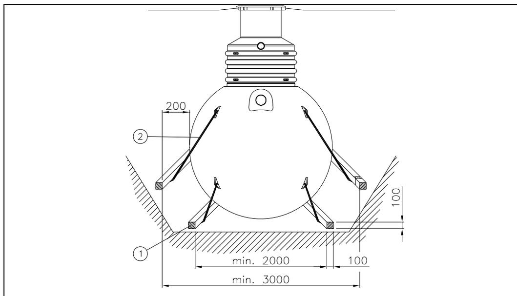
*Рис 4. Установка регулирующих колодцев NS50/150 – NS150/450 на антисептированные брусья.*
