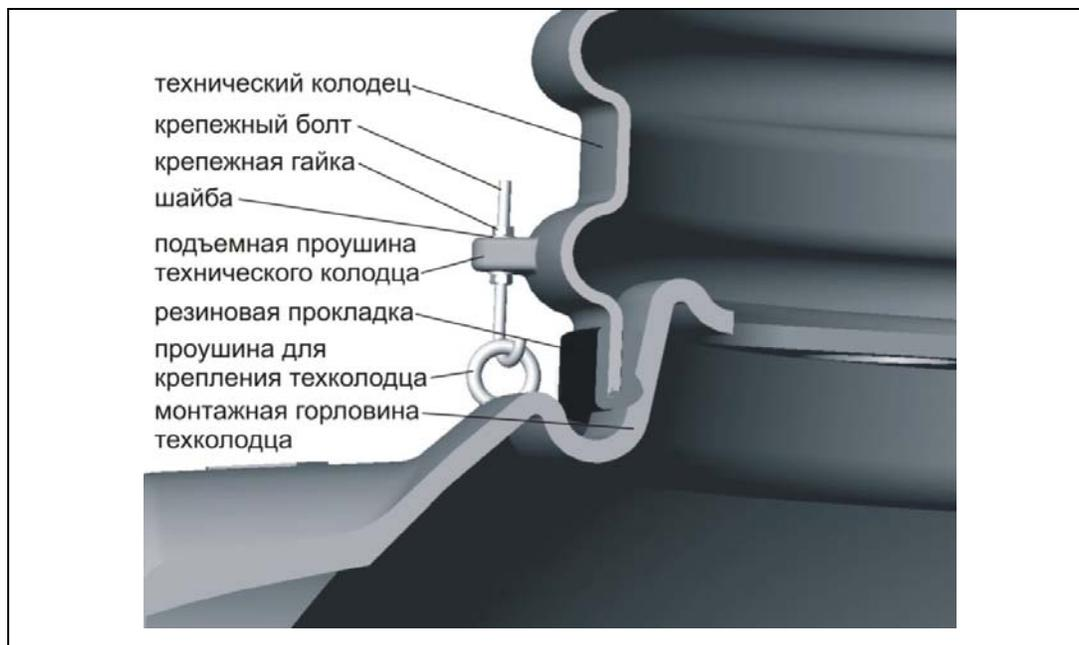
Рис 6. Установка технического колодца EuroHUK.
