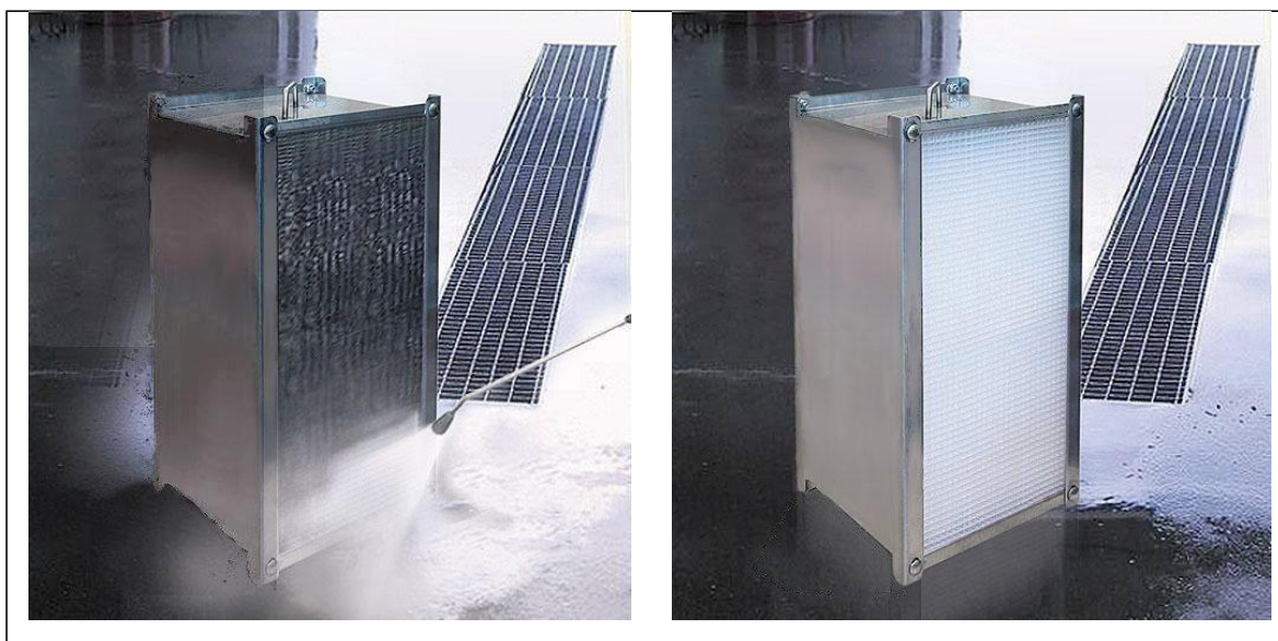
Рис 7. Промывка коалесцентного модуля водой под давлением и чистый коалесцентный модуль после промывки.
