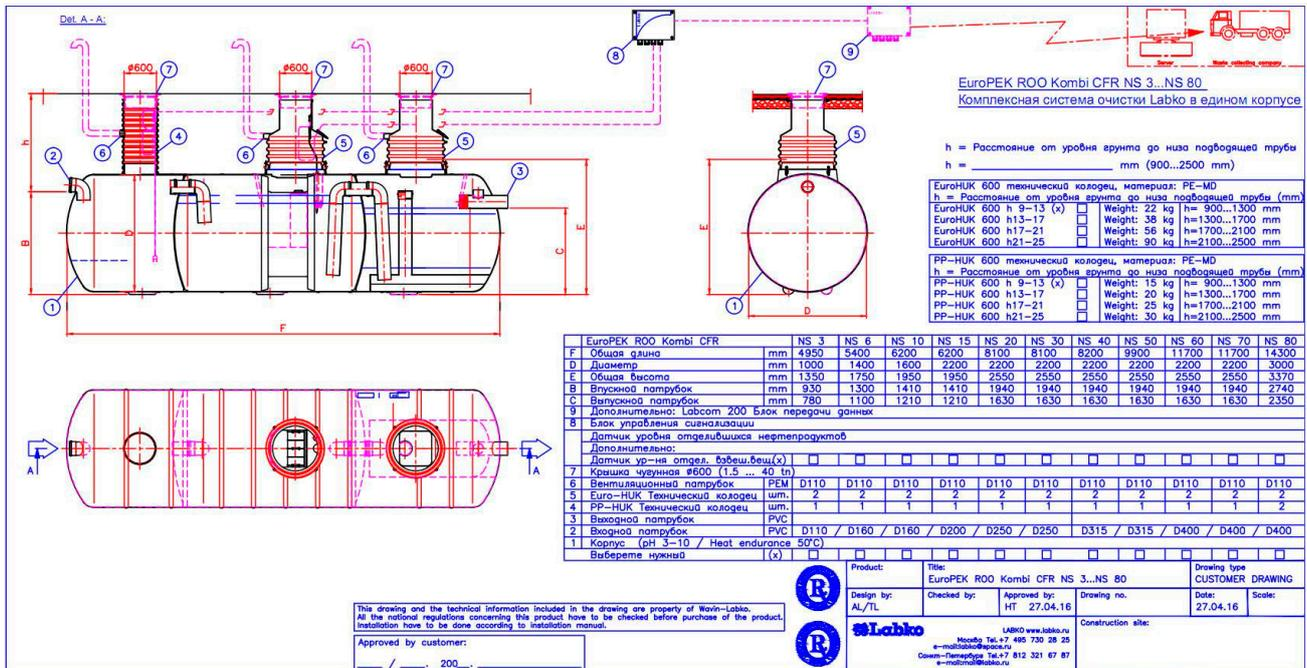
Рис. 1. Комплектация комплексной станции очистки EuroPEK Roo Kombi CFR.
