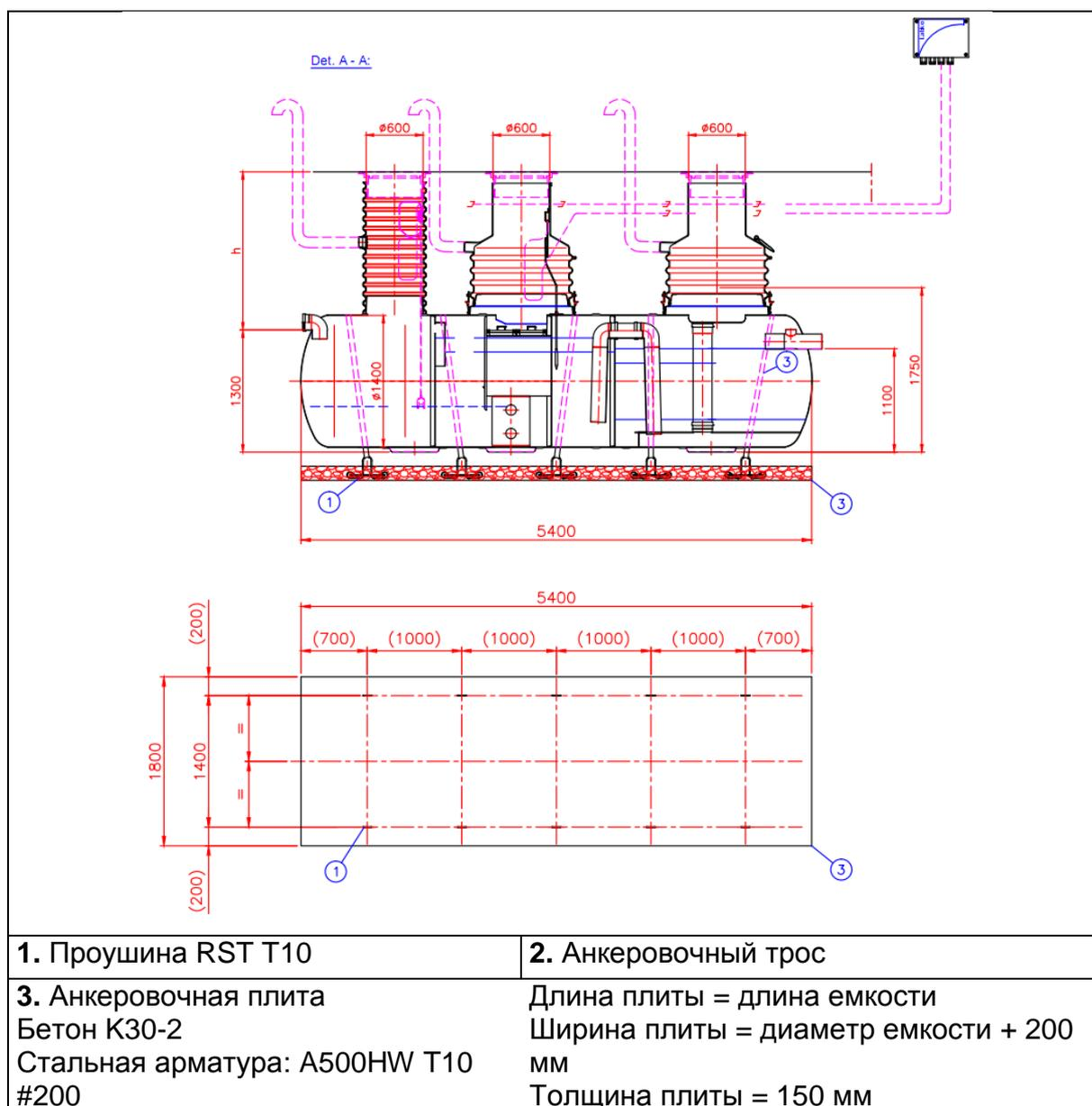
**Рис. 2.** Крепление корпуса при высоком уровне грунтовых вод или при слабо несущем грунте.
