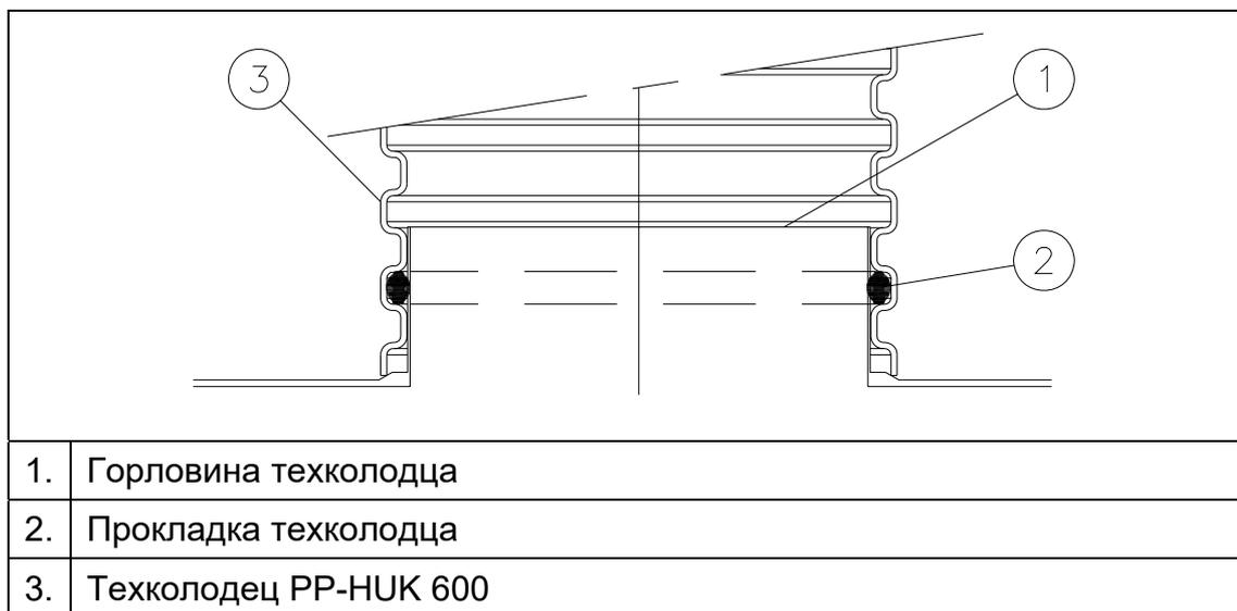
Рис. 5. Установка технического колодца PP-HUK
