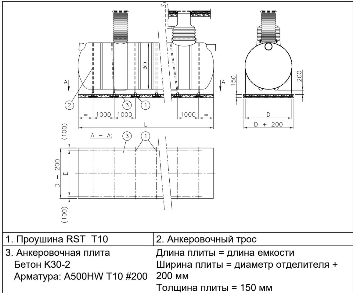
Рис. 3. Установка отделителя на бетонной плите
