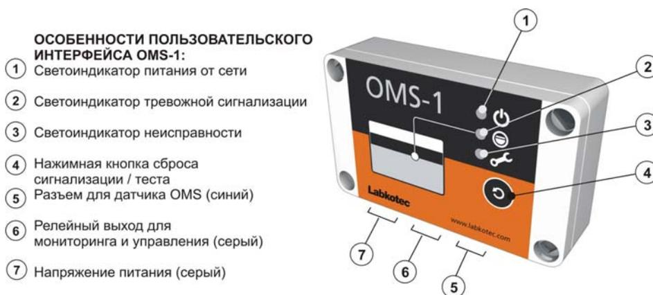
Рисунок 2. Элементы блока управления OMS-1
