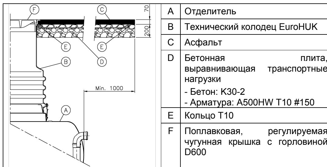
Рис. 4. Конструкция плиты, выравнивающей нагрузки
